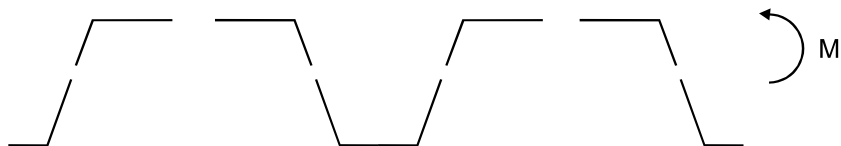
Σχήμα 6.5 ► Ενεργός διατομή χαλυβδοφύλλων
