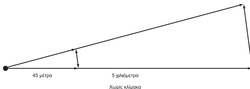
Εικόνα 10-5: Μια μικρή αλλαγή της γωνίας στη κατεύθυνση της κεραίας μπορεί να έχει τεράστιες επιπτώσεις στη σύνδεση, αν ο δέκτης βρίσκεται αρκετά χιλιόμετρα μακριά.
