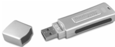
Εικόνα 4.27 Τυπική μορφή μνήμης flash για διασύνδεση USB
