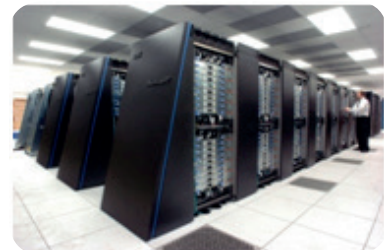
Εικόνα 1.2. Ο υπερυπολογιστής Blue Gene/P στο Argonne National Lab αποτελείται από περισσότερους από 250.000 επεξεργαστές.
